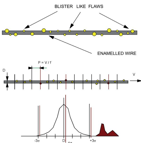
(\*) Le pas de balayage est donné par la vitesse du produit divisée par la fréquence de balayage de la jauge
