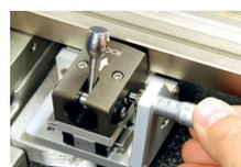
Dispositivo per la regolazione fine della posizione della slitta a testina micrometrica passo 0,5 mm/giro, corsa  $\pm 6,5$  mm
