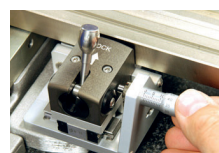
Vorrichtung z. Feineinstellung der Schlittenposition, mit mikrometrischem Kopf, 0,5 mm/U, Lauf \pm 6,5 mm
