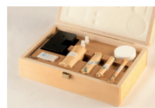
Satz von 4 Kalibrierstiften für XLS40 Mikrometer, mit Prismenblock zur Auflage.
