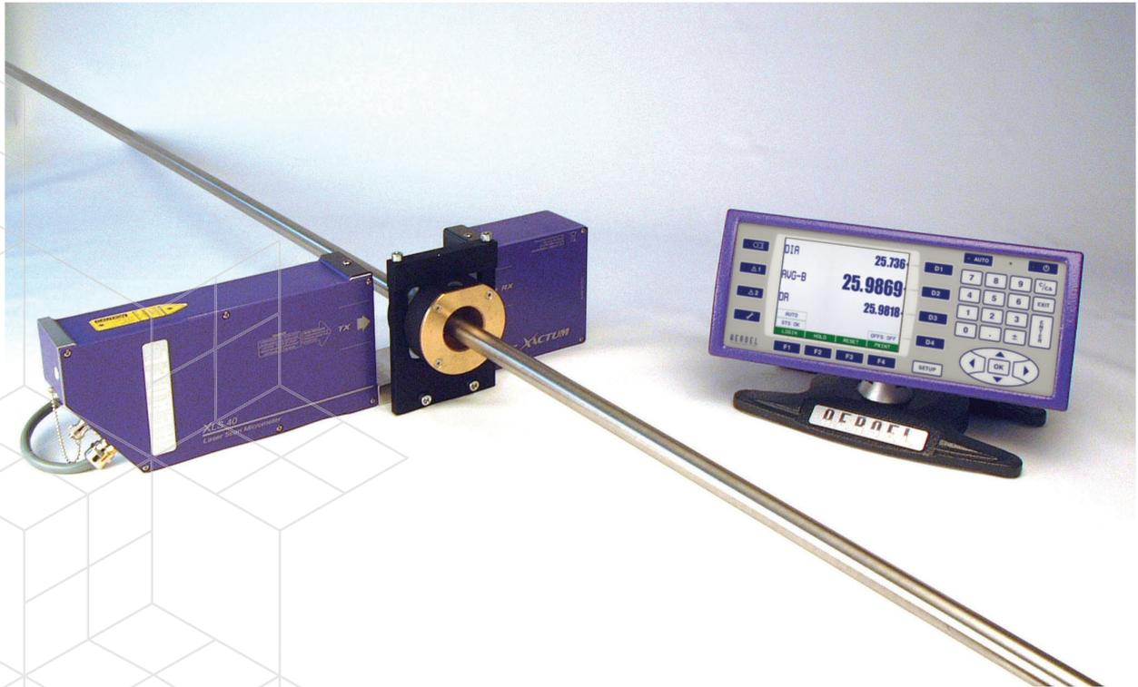
**Barline.X è un sistema laser per il controllo in linea del diametro esterno di prodotti lavorati in spezzoni, come barre di acciaio rettificate, tubi di ferro trafilati, tubetti in rame, o altri prodotti simili**
