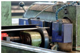
Il diametro medio rilevato viene continuamente comparato con il valore nominale programmato dall'operatore: quando il prodotto tende ad uscire dai limiti di controllo impostati, il software Barline X corregge
