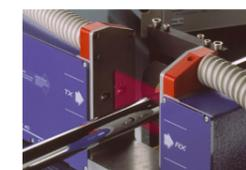
Finestre ad aria compressa per la protezione dell'ottica in ambienti gravosi.
