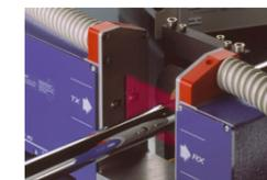
Anzeigefenster mit Druckluft für den Einsatz in staubigen Räumen.
