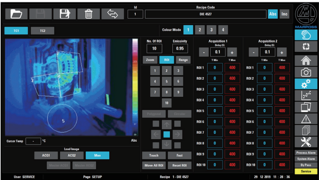
每个关注区域的含温度值的热像图和关注区域的设置参数。
