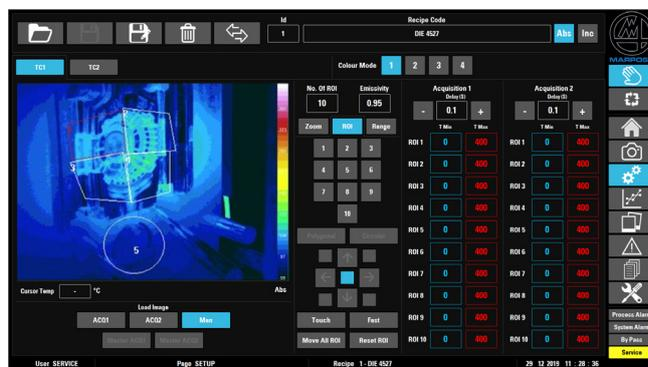
Immagine termografica con valori di temperatura per ogni ROI e parametri di setup della ricetta
