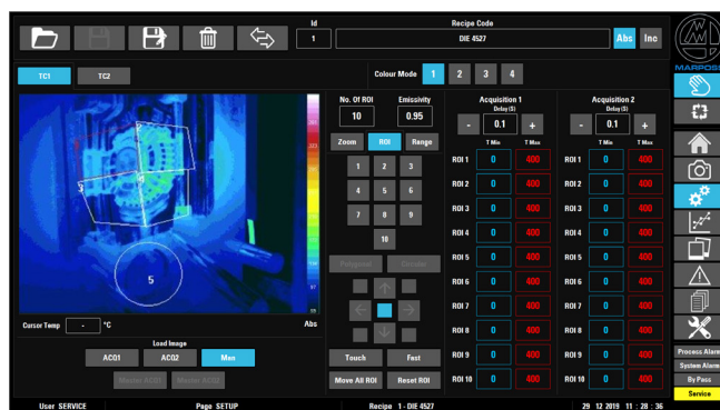
Image thermographique avec valeurs de température pour chaque région d'intérêt et paramètres de configuration de la recette
