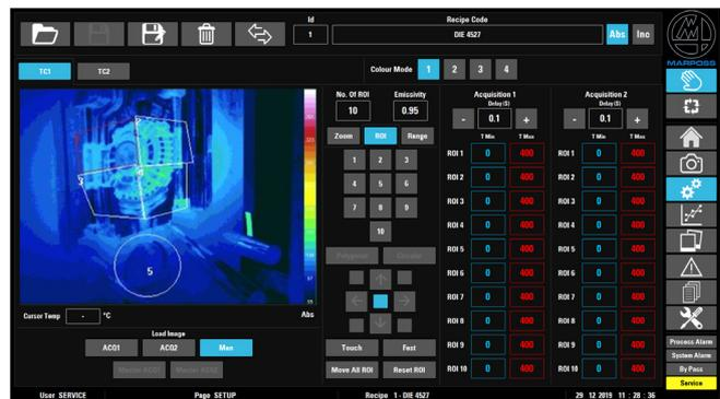
Imagen termográfica con valores de temperatura para cada ROI y parámetros de configuración de la receta
