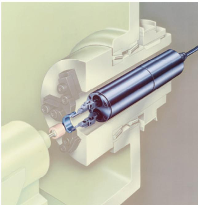
インプロセスの内径測定アプリケーションは、スピンドル内部に取付けられた測定ヘッドとP7電子制御ユニットで構成されています。
