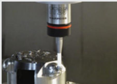
**NEW! VOP40L****SYSTEME DE MESURE POUR TOURS A TRANSMISSION OPTIQUE MULTICANAL**
