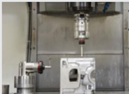
constituyen un sistema completo para el control de la pieza y la herramienta con una sola interface
