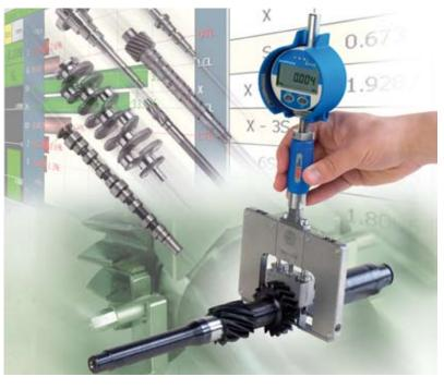
Messungen an Werkstücken, die mehr Raum zum Aufsetzen des Prismas bieten, können Auflageprismen mit 20mm Breite verwendet werden.
