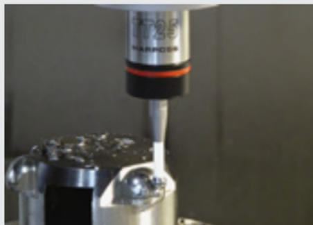
**NEW! VOP40L****SISTEMA DI TASTATURA PER TORNI CON
