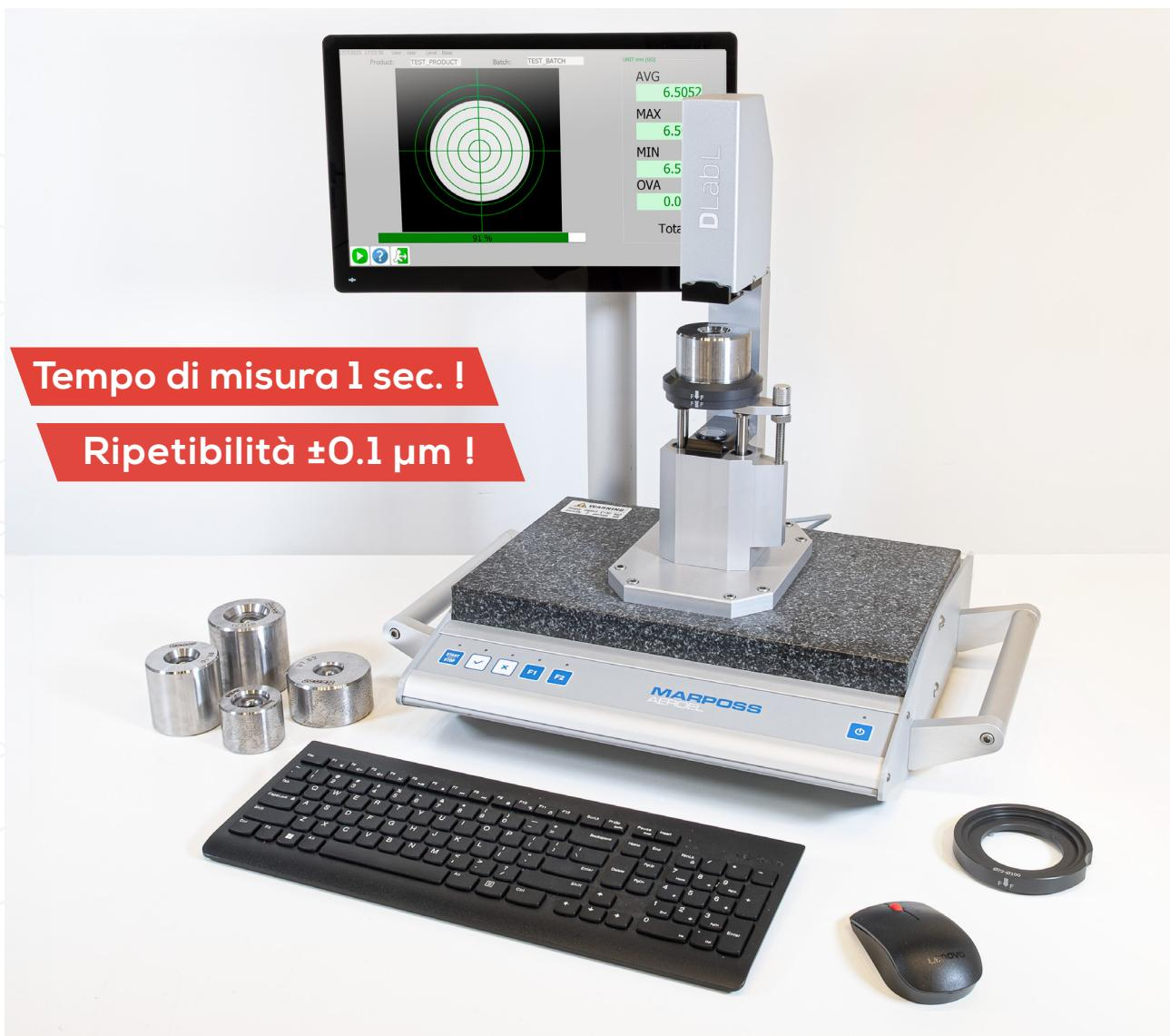
D-Lab è un sistema ad alte prestazioni, facile da usare, per il controllo delle filiere.
