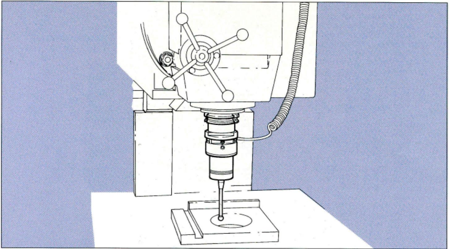
Das Schaltmeßsystem E88 von MARPOSS dient zur Werkstückkontrolle auf CNC-Maschinen mit manuellem Werkzeugwechsel. Es kann zur Bestimmung des Werkstücknullpunkts, zum Ausrichten der Werkstückkoordinaten und zur dimensionellen Massaufnahme verwendet werden.
