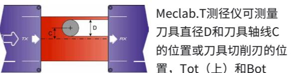
Meclab.T测径仪可测量刀具直径D和刀具轴线C的位置或刀具切削刃的Top (上) 和Bot (下)，其值全部为相对测量区的中心位置。
