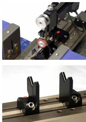
置于花岗石基座上的精密线性导轨：带V形槽的不锈钢工作台，总长400 mm，可用范围160 mm，手动微分螺杆驱动
