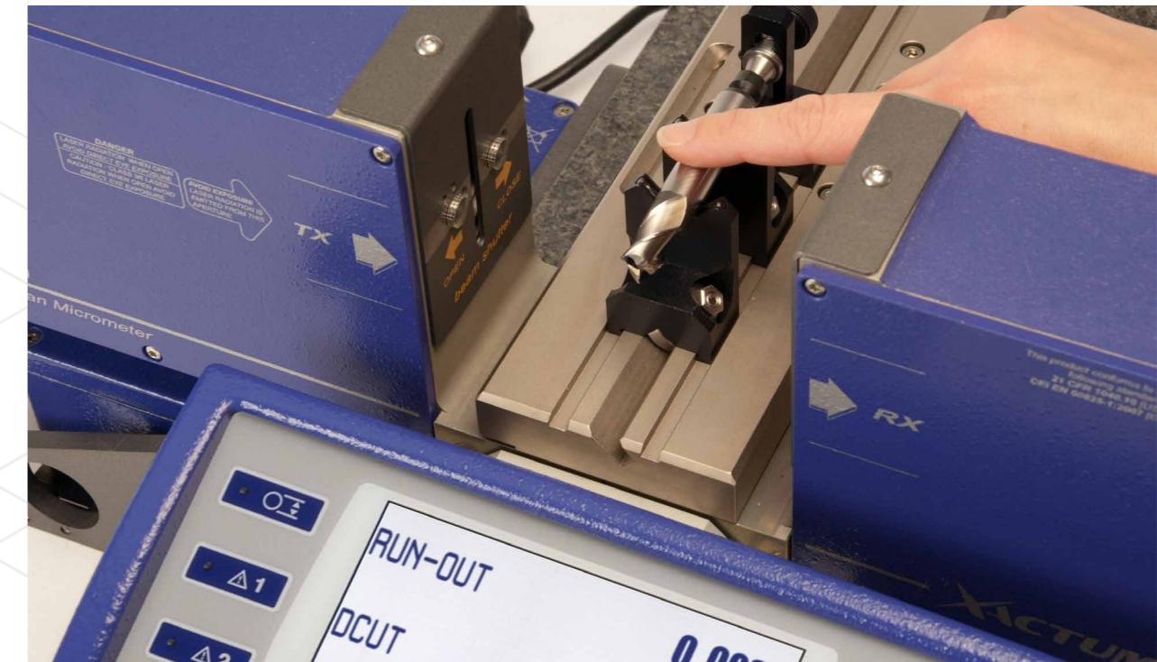
MECLAB.T40激光测径仪测量精度高，可快速和轻松测量硬质合金胚料、完整的硬质合金刀具的直径，包括奇数或偶数切削刃的刀具。对于以下刀具，这是线下检测的理想选择：
