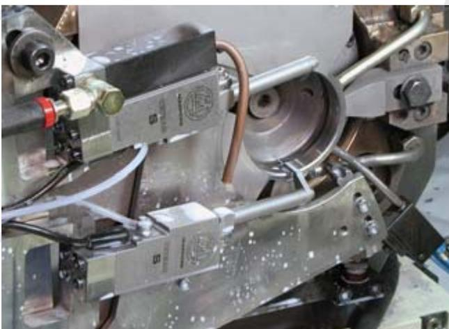
Applicazione per il controllo di diametri interni
