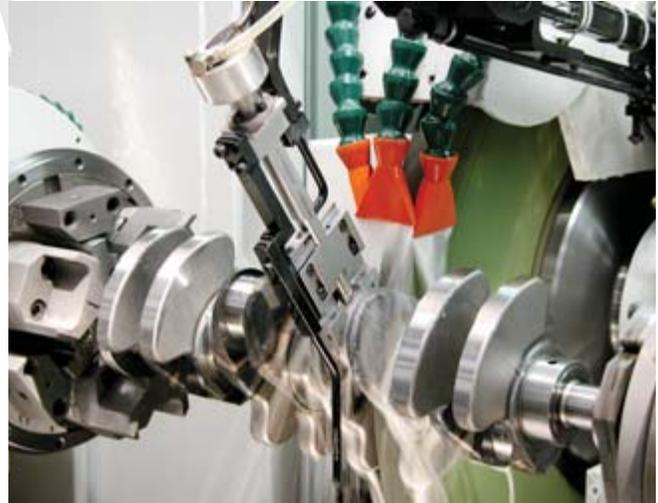
*Mesureur pour le contrôle sur rectifieuse de pieds de bielle dans les arbres moteurs*
