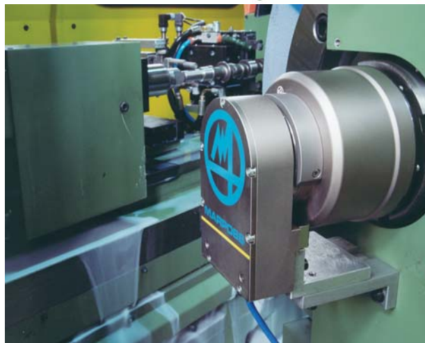
9 – Externí vyvažovací hlava s infračerveným přenosem
