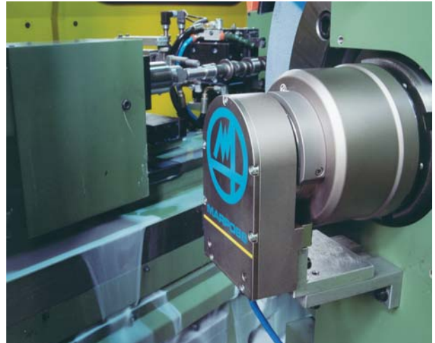
9 - Tête équilibreuse externe à transmission infrarouge
