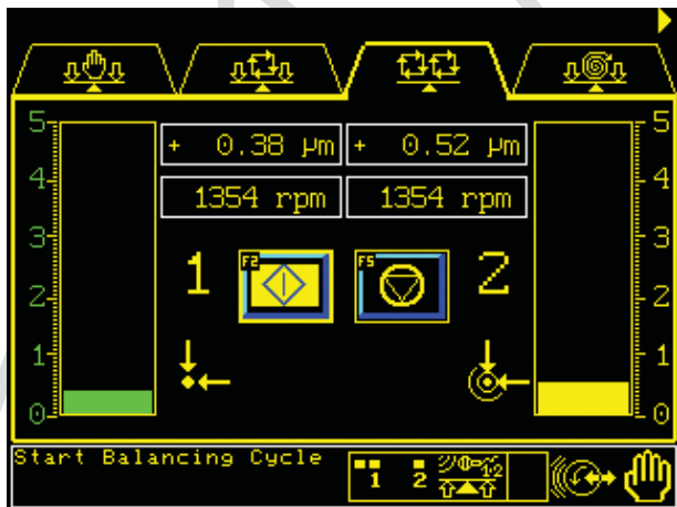
6 - Equilibrado dinámico para aplicaciones o doble muela
