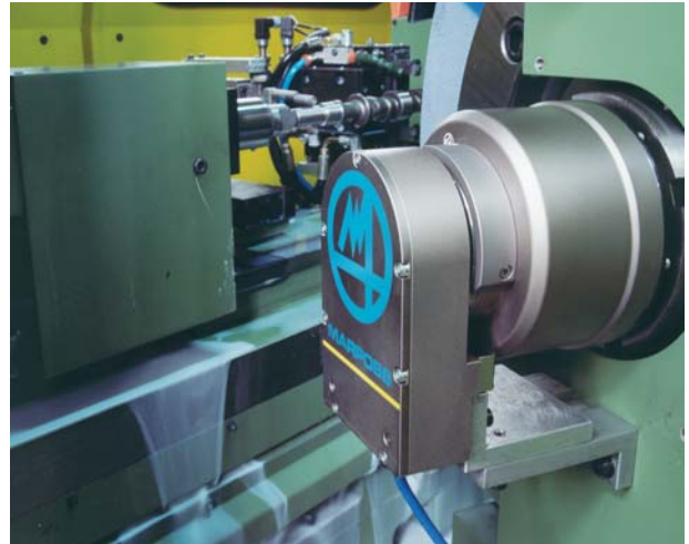
9 - Cabezal equilibrador con transmisión infrarrojos
