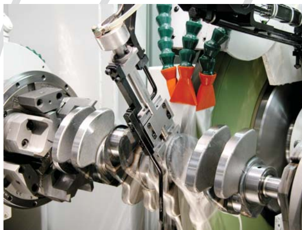
5 - Aplicación de control de muñequillas y apoyos
