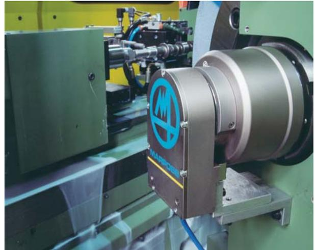
9 - Externer Auswuchtkopf mit Infrarotübertragung
