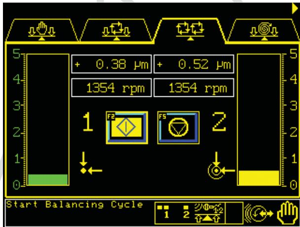
6 - Dynamische Auswuchtung für Einrichtungen mit doppelter Schleifscheibe
