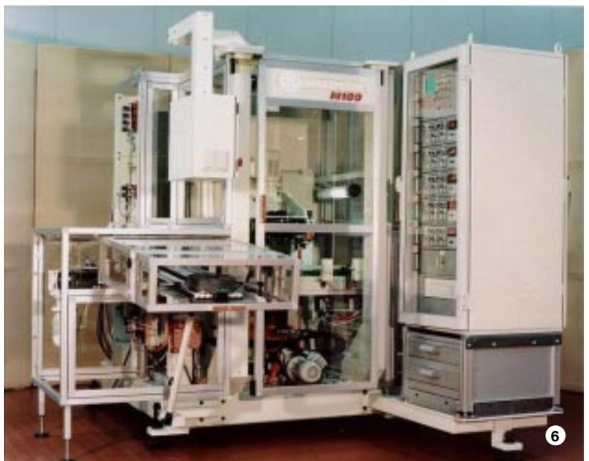
4 - Dispositivo de calibrado automático
