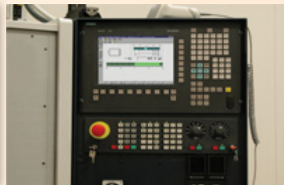
Řešení s displejem integrovaným do NC řídicího systému
