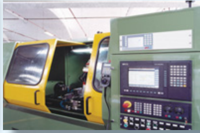
Lösung mit externer Steuertafel
