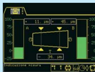
Mesure Avant Usinage- 2 diamètres + conicité
