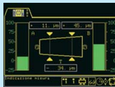
Medida IP - 2 diámetros + conicidad
