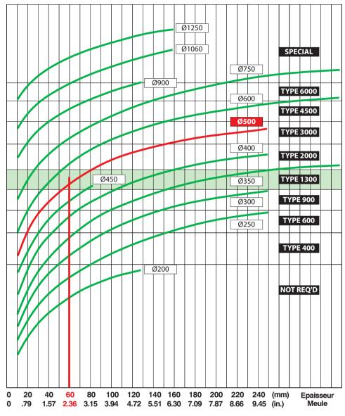
Ce diagramme permet de définir la capacité d'équilibrage et le modèle de tête d'équilibrage les plus appropriés pour une meule agglomérée traditionnelle : sélectionner la courbe correspondant au diamètre externe de la meule à équilibrer et définir sur celle-ci le point relatif à la largeur de la meule. Le modèle recommandé de tête d'équilibrage est indiqué à droite.
