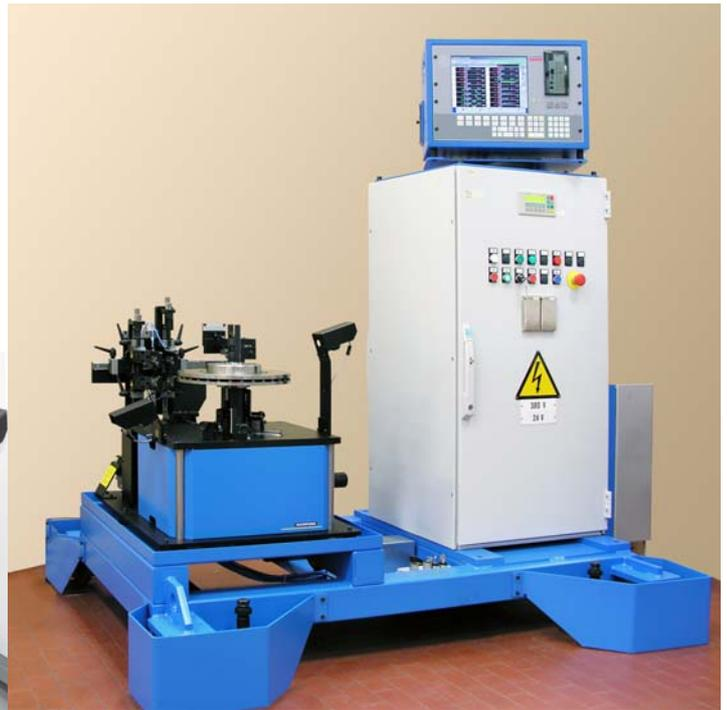
Applicazione multiquota per il controllo di dischi freno industriali.
