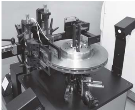
Mehrstellenmessvorrichtung für die Kontrolle von Kfz-Bremsscheiben.
