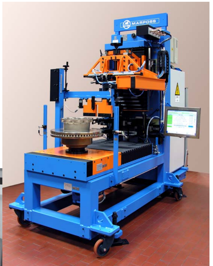
Mehrstellenmessvorrichtung für die Kontrolle von Industrie-Bremsscheiben.
