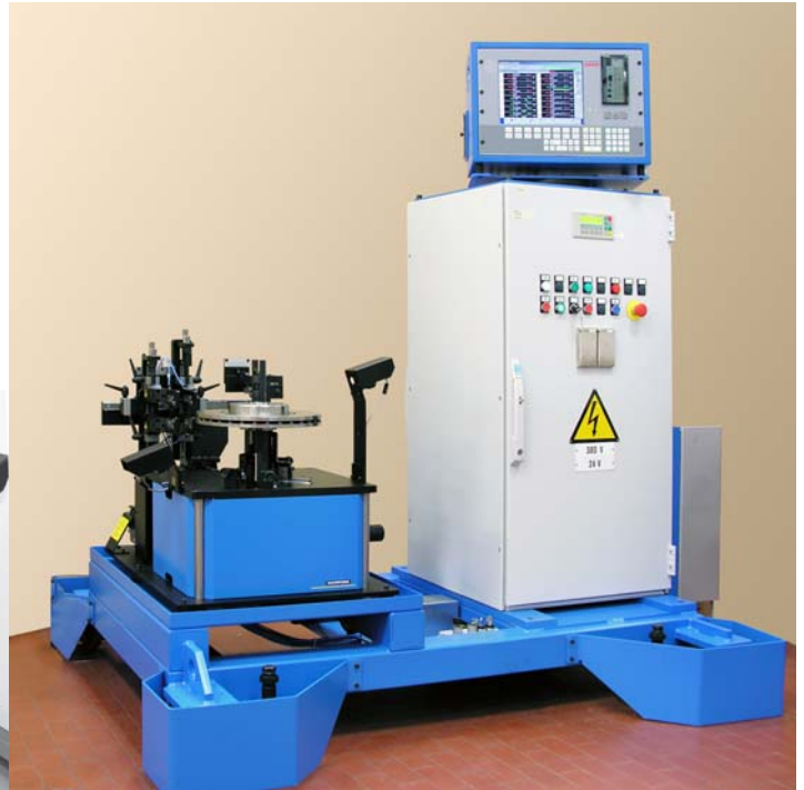
Mehrstellenmessvorrichtung für die Kontrolle von Kfz-Bremsscheiben.
