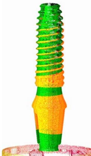
3D-Messungen basieren auf tausenden von Punkten auf der Werkstückoberfläche. Deshalb sind unregelmäßige Werkstückprofile, wie Gewinde, perfekte Anwendungen, bei denen Optoflash mit seinem 3D-Modul den entscheidenden Unterschied zu herkömmlichen Anwendungen macht.
