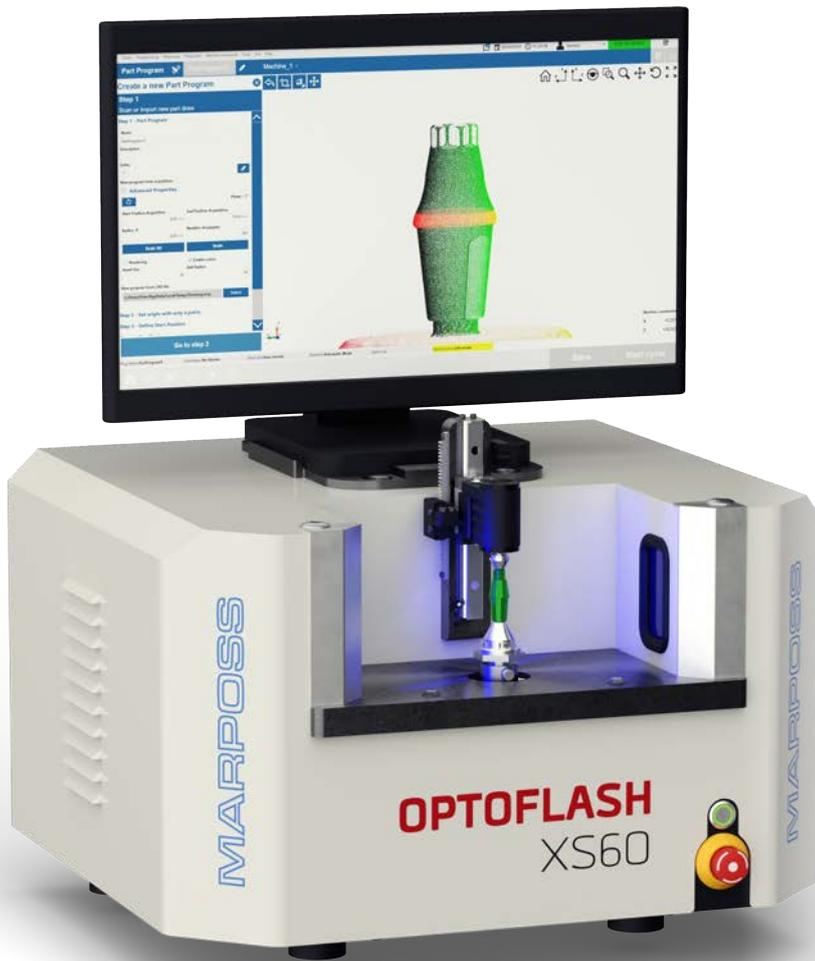
Das Messergebnis kann schnell auf dem Optoflash-Display bewertet werden. Qualitätsabweichungen werden direkt anhand von Bildern diagnostiziert, unterstützt von der intuitiven Visualisierung und interaktiven 3D-Navigation.
