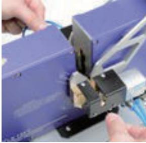
専用フィクスチャーを使用して手でパーツを回転させることにより、径の全周を測定し、最大 MAX-D、最小 MIN-D、および実際の MAX-D - MIN-D である楕円度を正確に測定できます。測定値は、非常に見やすいバックライト付き LCD ディスプレイに表示されます。測定値は公差限界値と比較され、ワークの寸法の一致性がチェックされます。
