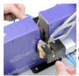
専用フィクスチャーを使用して手動でパーツを回転させることにより、径の全周を測定し、最大 MAX-D、最小 MIN-D、および実際の MAX-D - MIN-D である楕円度を正確に測定できます。測定値は、非常に見やすいバックアストスによった。
