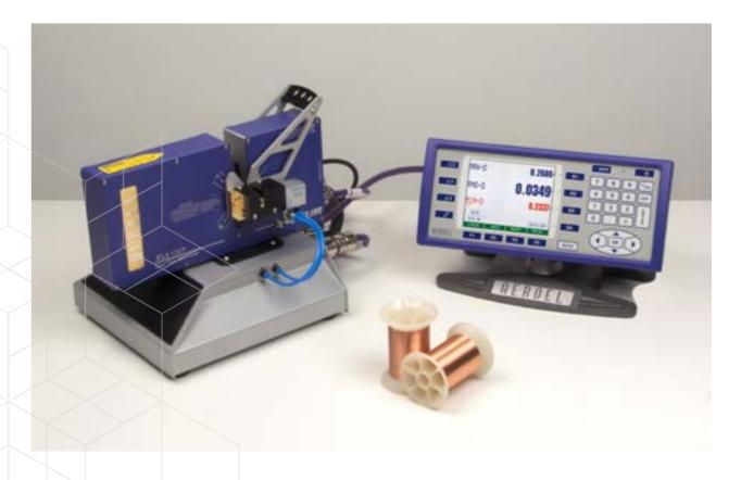
WIRELAB.XY は高性能なテーブルトップ型レーザーマイ クロメーターで、直径や楕円度の正確な測定を必要とする 引抜きまたは押出し成形された製品をオフラインでチェッ クできるように設計されています。
