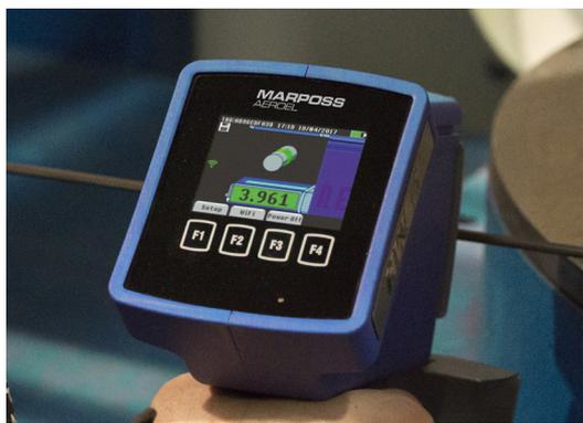
**La misura** si avvia con la pressione del grilletto e **richiede pochi secondi**; il display fornisce all'operatore una visualizzazione 3D per posizionare il filo nella zona utile di misura e visualizza il risultato della misurazione.
