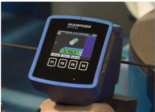
**Der Messvorgang wird** durch Druck auf den Auslöser begonnen und **dauert nur wenige Sekunden**; Das Display gibt dem Anwender eine '3D'-Visualisierung zur Positionierung des Drahtes im Messbereich und zeigt das Messergebnis an.
