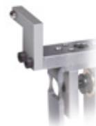
Das Tastarmverhältnis 1:1 bleibt, unabhängig von der Abkröpfung, innerhalb des Bereichs, da die Bewegung über ein Parallelogramm und nicht um einen Drehpunkt erfolgt.
