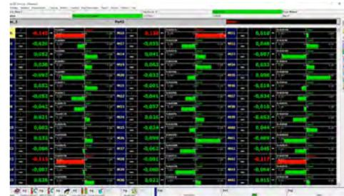
Glass ADDON muestra de manera rápida e intuitiva la medición realizada en el vidrio gracias a la posibilidad de importar el archivo 3D. El algoritmo Best-fit supera un posicionamiento incorrecto del vidrio en el accesorio de medición. Puede incorporarse de manera fácil elaboraciones de medición (índice de cambio, ángulo de ataque, etc.) y mostrarse en páginas específicas.
