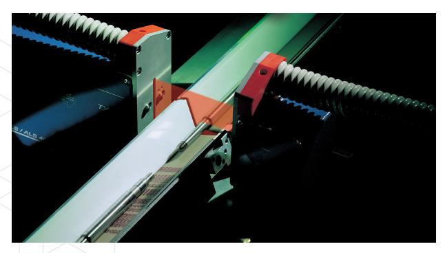
Grindline+.X レーザーシステムは、センタレス研削盤で製造された製品(電気駆動モーターや多段径でセンタ穴の無い部品等)の外径を生産ライン上で測定するために設計されています。
