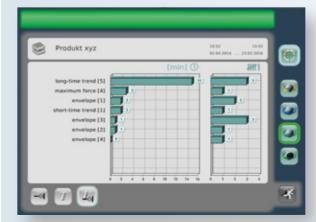
故障分布显示机器停机时间和过程故障频率,以便进行
