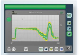
加强版自动优化能够自动确定整个包络曲线的最佳灵敏度(包络宽度)。
