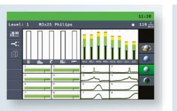
全局式操作界面一目了然显示所有相关信息,计数器读数,每个通道的最大力,包络曲线以及趋势极限
