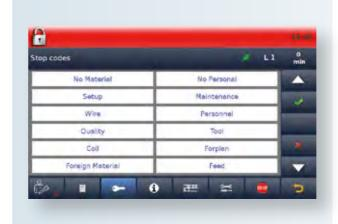
在配置列表中,操作员可自定义显示和选择停机代码 如果操作员输入错误,机器将会被锁定
