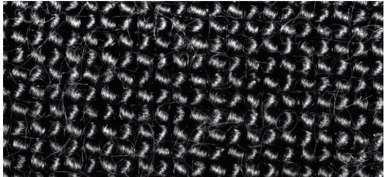
MC2高分辨率共焦线扫相机进行表面扫描
