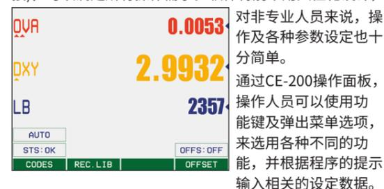
对非专业人员来说，操作及各种参数设定也十分简单。通过CE-200操作面板，操作人员可以使用功能键及弹出菜单选项，来选用各种不同的功能，并根据程序的提示输入相关的设定数据。
