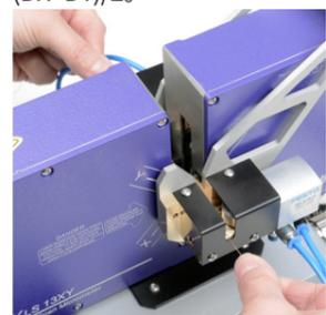
使用专用夹具以手动方式旋转被测工件，可有效检测超过 360° 的圆周直径，并精准测量出外径最大值MAX-D，最小值MIN-D 和实际椭圆度值 MAX-D-MIN-D。
