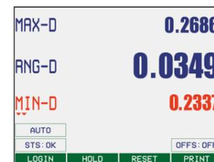
Continuous连续模式用于检查剖面的完整几何形状，沿样品圆周的360°进行几个读数。最大和最小直径以及Max-Min值被保留，这是样品的真实椭圆度。
