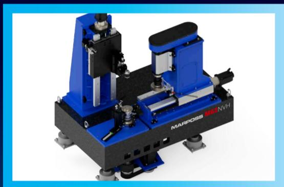
在零件级别评估NVH比在最终装配成品上评估更有优势，因为在单个零件上识别缺陷（如轮齿的宏观尺寸误差）可以避免在装配阶段发现问题。此时发现可能已经太晚，难以改善零件。
