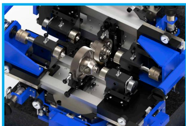
Marposs单啮测试系统可用于在实验室中测量试制样件，以验证齿轮设计过程。该测量系统也可测量变速箱（减速器）样品中待测样件相比于master，或待测样件相比于共轭齿轮的尺寸偏差。操作人员甚至可以调节齿轮中心距及轴线倾斜角，以最大化降低噪音。
