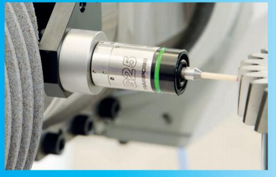
该监控系统旨在检测出磨削过程中的尺寸最小变化，从而在砂轮接触零件或修整器时能够极精确得控制进给速度。该系统尤其可以防止加工过程中的碰撞，检测机器或工装的故障，检测砂轮上的碎片，以及检测修整器的缺陷。
