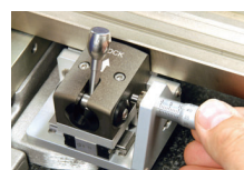
スライド位置微調整装置、マイクロ メータヘッド付き、ピッチ0.5 mm/ 回転、範囲±6.5 mm
