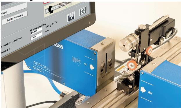
Der Tischmikrometer SUPERMECLAB+.T40 ist ein Lasergerät für die sorgfältige und Kontaktfreie Kontrolle des Durchmessers von Objekten mit Nuten, gerade oder ungerade Nuten. Es eignet sich besonders für die Off-Line Prüfung von
