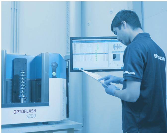
La calibrazione periodica viene eseguita tramite uno strumento software dedicato e da calibri specifici che consentono una messa a punto delle mappature del prodotto direttamente in loco.
